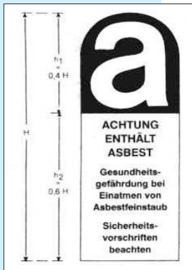
Abb. 7: Kennzeichnung nach der Asbestverordnung
