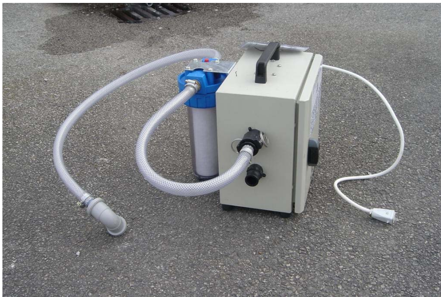
Abb. 8.1 Filtrationseinheit fuer das abflusswasser aus der dekontaminierungseinheit. diese abbildung wurde von der uk hse zur verfügung gestellt.auswahl und verwendung der atemschutzausrüstung
