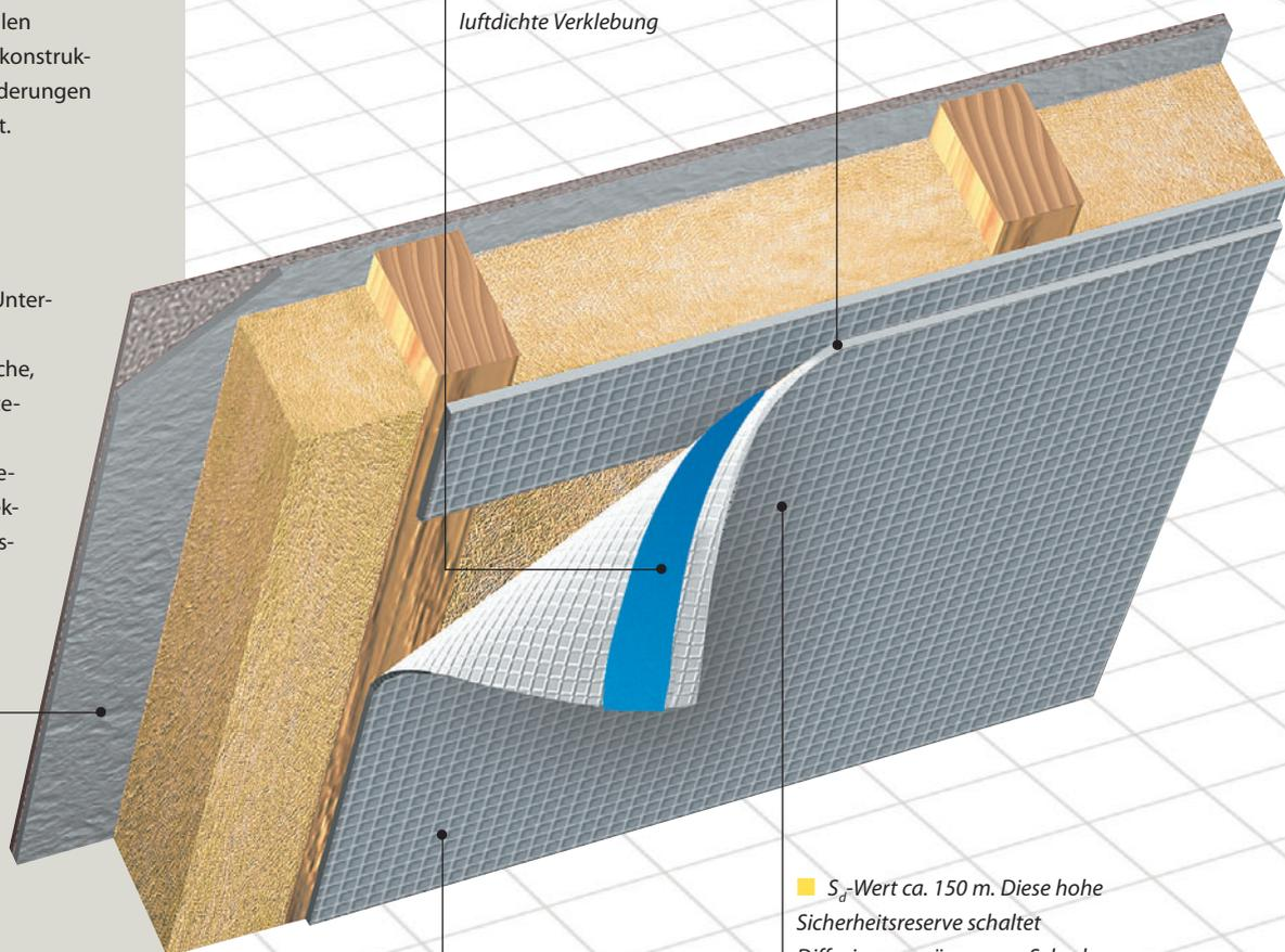
**■  $S_d$ -Wert ca. 150 m.** Diese hohe Sicherheitsreserve schaltet Diffusionsvorgänge zum Schaden der Wärmedämmung und der Dachkonstruktion langfristig aus
