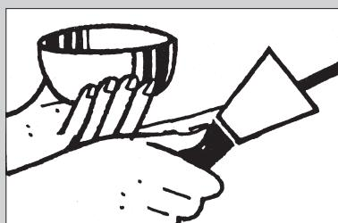
Überstände der Plattenstösse mit einer Dispersionspachtelmasse ausgleichen. Eventuell grössere Fugen mit Superwand-Streifen verfüllen (gleicher Isolationswert) und ebenfalls abspachteln.
