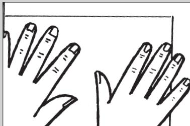
Superwand DS® unter leichtem Druck mit der Rolle sorgfältig anpressen. Noch besser ist das anklopfen mit Gummihammer und Hartholzbrett.
