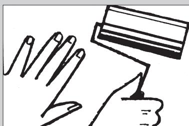
**Trocknungszeit:** Je nach Temperatur des Untergrundes und der Raumluft mindestens 5 Tage. In Extremfällen (Wintermonate) kann sich die Trocknungszeit erhöhen. In jedem Fall vorher eine Klebeprobe durchführen.
