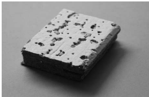
Teil einer asbesthaltigen Akustikplatte, Foto IST
