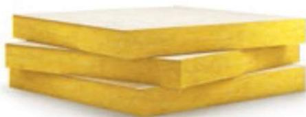
Nicht brennbare, einseitig mit weißem Glasvlies kaschierte Dämmplatte aus Recyclingglas zur Wärme- und Schalldämmung, mit Vliesüberstand an zwei gegenüber liegenden Seiten.
