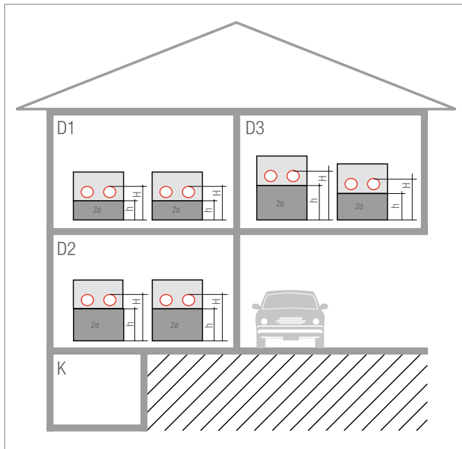
Abb. 4-126 Mindestdämmschichtaufbauten beim System Rohrträgermatte
