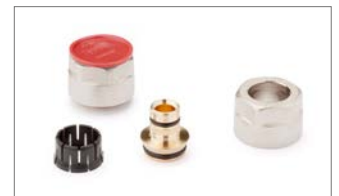
Abb. 3-22 Klemmringverschraubung für Rohre RAUTHERM SPEED, RAUTHERM SPEED K, RAUTHERM S der Abmessungen 14, 16, 17, 20
