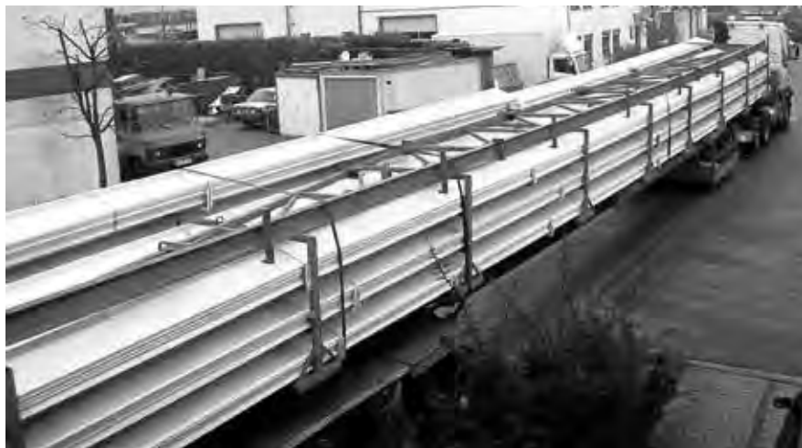
Abb.: Dachprofile-Transport mit einer Traverse zum Entladen
