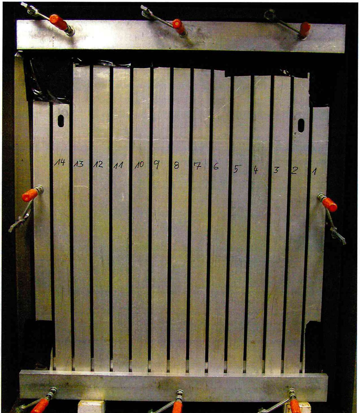
Bild 5: Beregnungsstand mit eingebautem Versuchskörper
