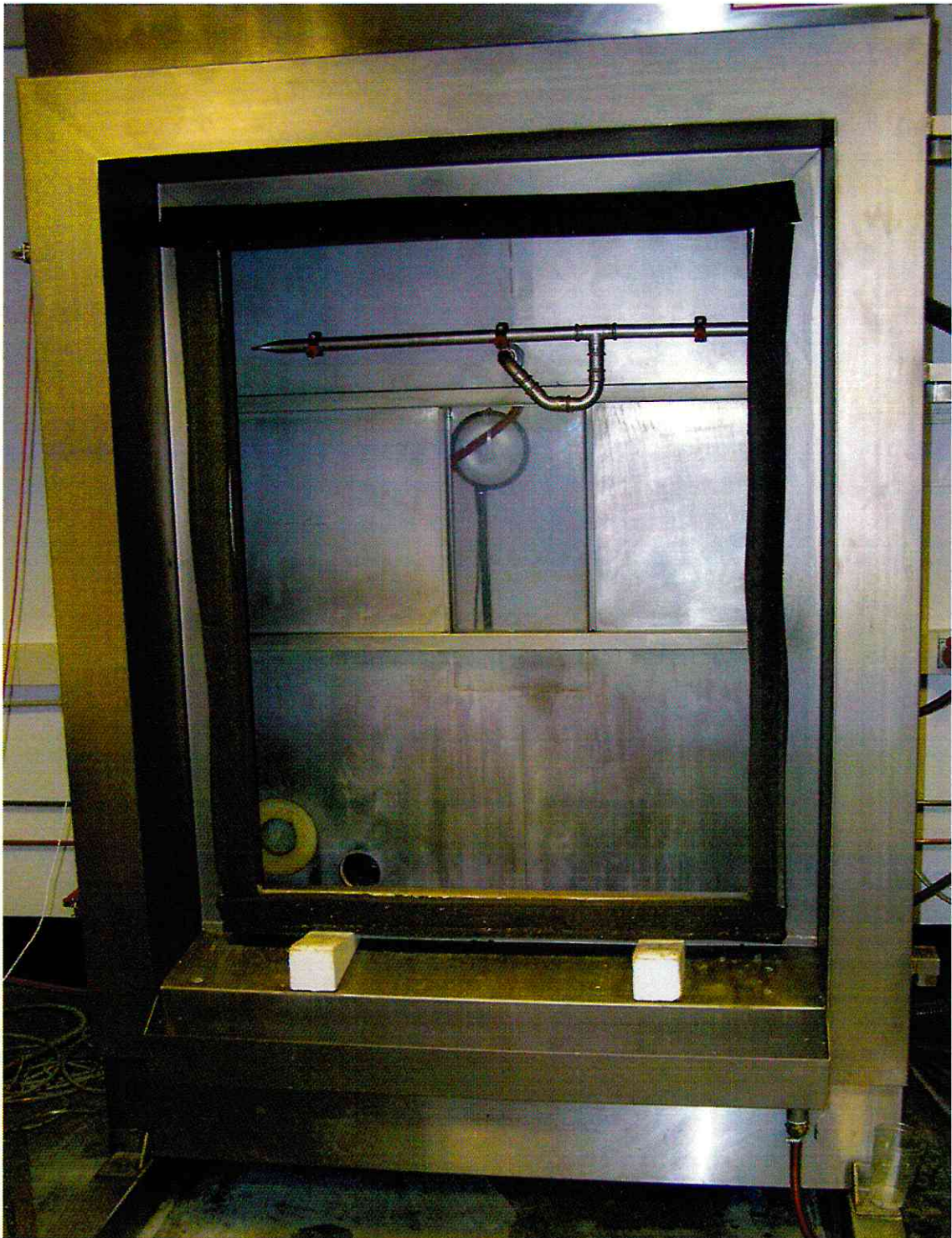
Bild 2b: Offener Prüfstand ohne den eingesetzten Versuchskörper
