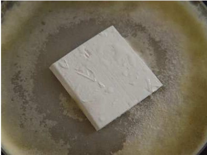
Bild 1, Verfahren A: Prüfkörper nach 4 Wochen Bebrütungszeit
