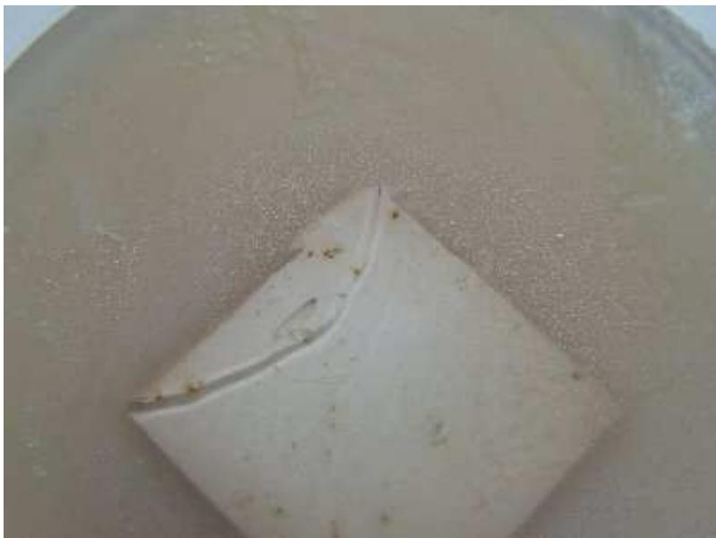
Bild 2, Verfahren C: Prüfkörper nach 4 Wochen Bebrütungszeit
