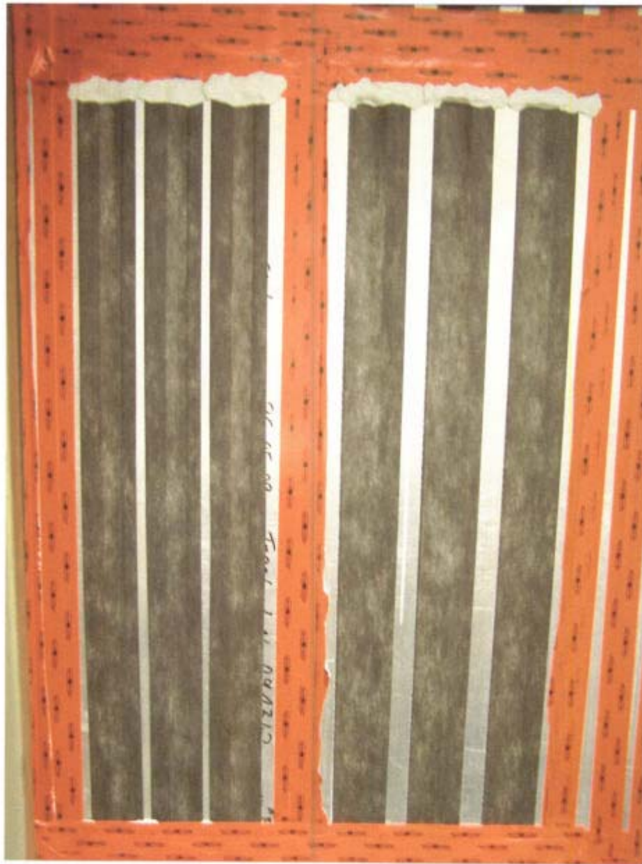
Bild 4: Versuchskörper, bestehend aus Hohlkammerprofilen (Querschnitt 60 mm x 100 mm) mit dazwischen befindlichen Fugen, über die die zu prüfenden Dichtbänder angebracht wurden. Die Zwischenräume werden durch Distanzstücke an den Enden auf die gewünschte Fugenbreite gebracht (hier 26 mm und 50 mm).
