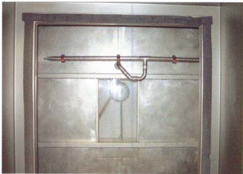
Bild 2: Offener Prüfstand mit Anordnung der drei wassersprühenden Düsen
