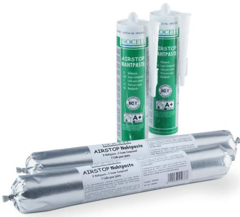
Um die Luft- und Winddichtheit der Gebäudehülle zu gewährleisten, müssen die dafür vorgesehenen Folien oder Plattenwerkstoffe an Überlappungen, Fugen, Anschlüssen und Durchdringungen dauerhaft abgedichtet werden. Die AIRSTOP Nahtpaste ist eine Montage- Klebedichtmasse zur dauerelastischen, luftdichten Abdichtung von Fugen, Bauteilanschlüssen und Stoßüberlappungen im Trockenausbau (ausgenommen im Schwimmbadbereich) und z. B. der Fenster- und Türenmontage gemäß ÖNORM B 5320 bzw. DIN 4108-7.
