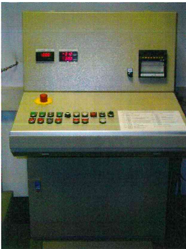
Bild 3a: Prüfstand-Steuerung (Drucksteuerung)
