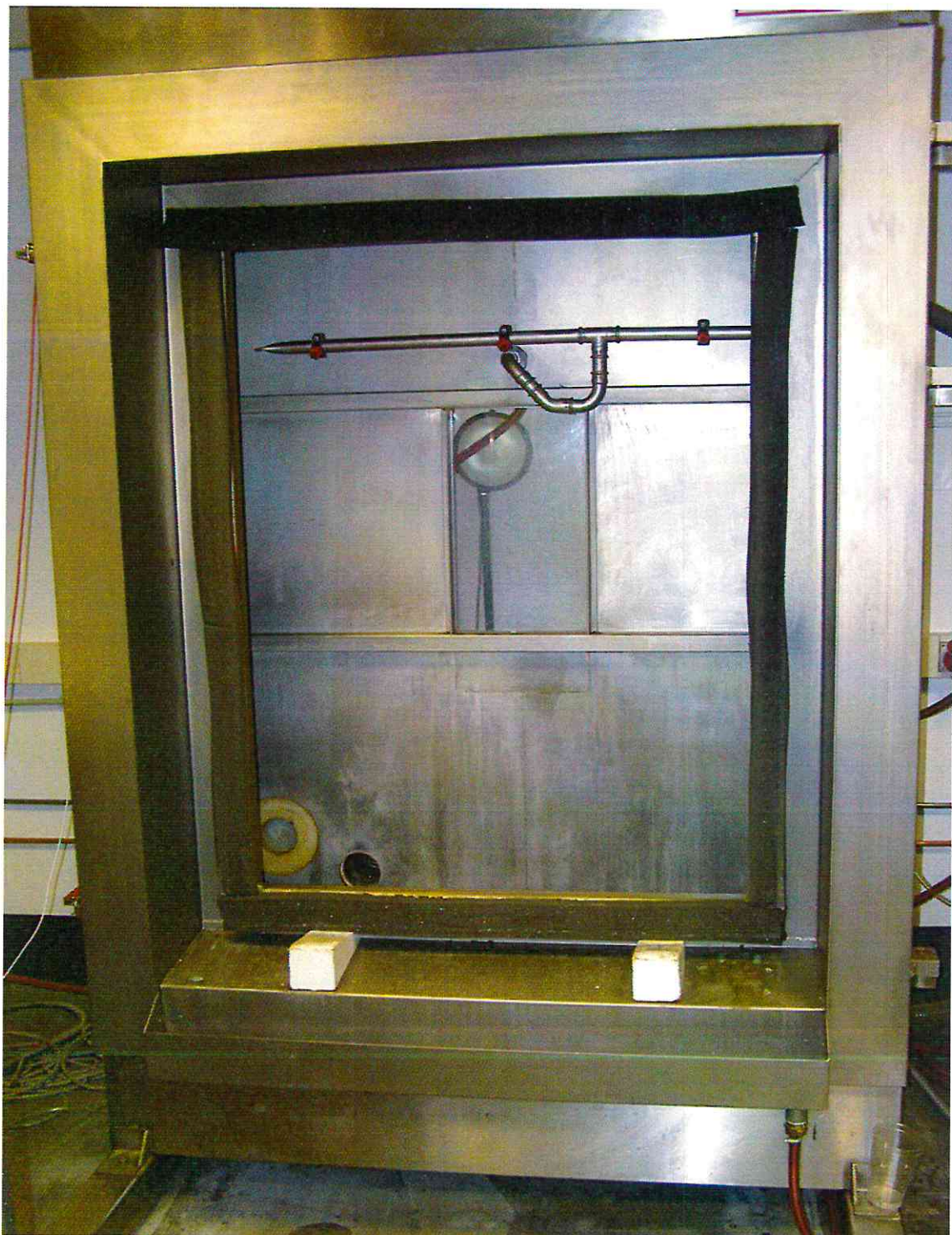
Bild 1: Offener Prüfstand ohne den eingesetzten Versuchskörper
