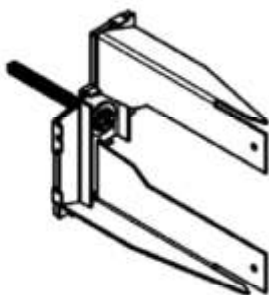
mögliche Wandaufbauten mit Domico Wandabstandshalter und Modulleiste BH 85 mm
