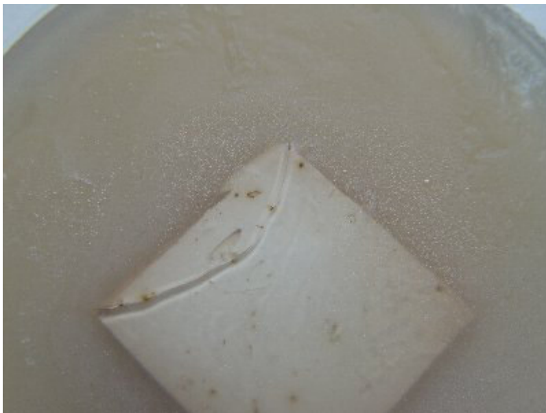
Bild 2, Verfahren C: Prüfkörper nach 4 Wochen Bebrütungszeit
