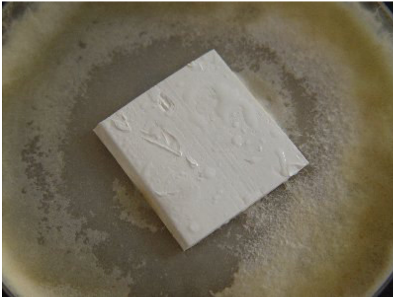
Bild 1, Verfahren A: Prüfkörper nach 4 Wochen Bebrütungszeit
