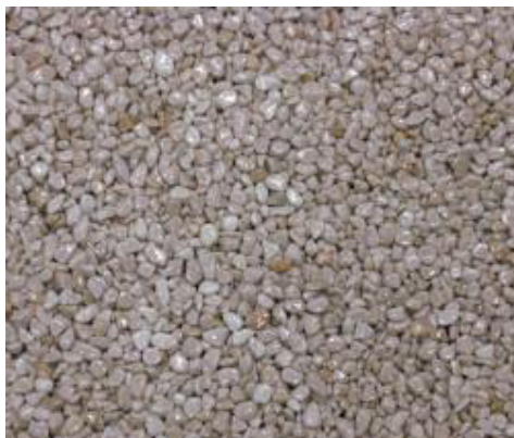
Applikation von Mapefloor I 910 auf natürlichen Zuschlägen
