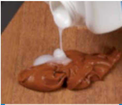
Mischen von Merbau Schleifstaub mit Ultracoat Binder
