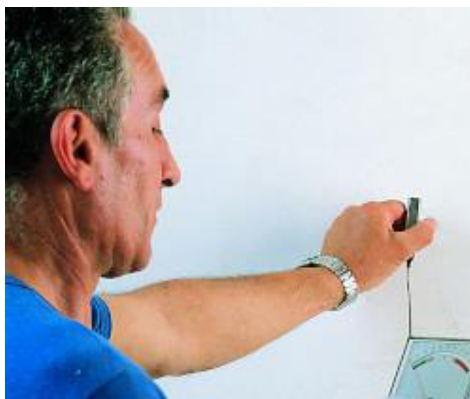
Feuchtemessung des Putzuntergrundes
