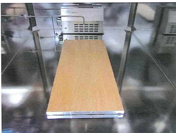
Abbildung 1: Prüfkörper in der Emissionsprüfkammer
