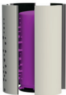
Bild 5: Aufstellen der Teilkreissschalen.
