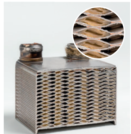
Plattenwärmetauscher (Frischwassermodul): Bedingt durch die engen Abstände im Plattentauscher kommt es häufig zu irreparablen Verkalkungen.
