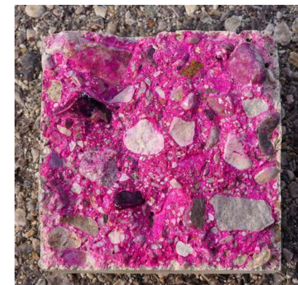
Carbonatisierungs-Prüfung zum Nachweis der Dauerhaftigkeit
