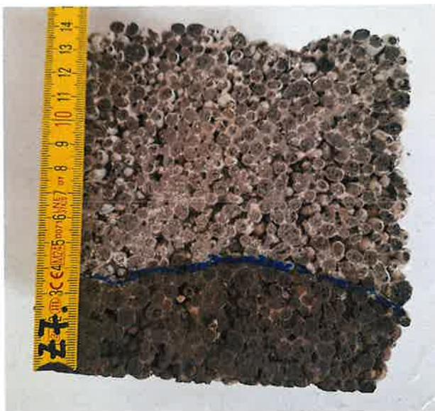
Foto 3: Wassersaughöhe - Probe 2 (Kern)
