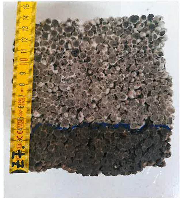
Foto 2: Wassersaughöhe - Probe 1 (Kern)
