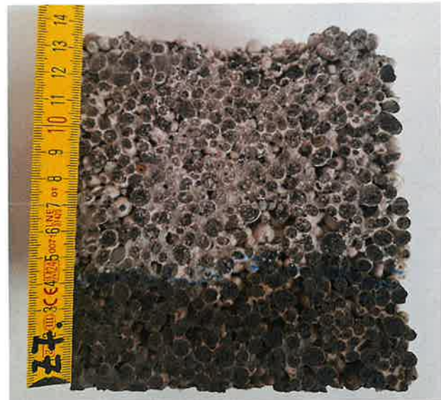
Foto 4: Wassersaughöhe - Probe 3 (Kern)
